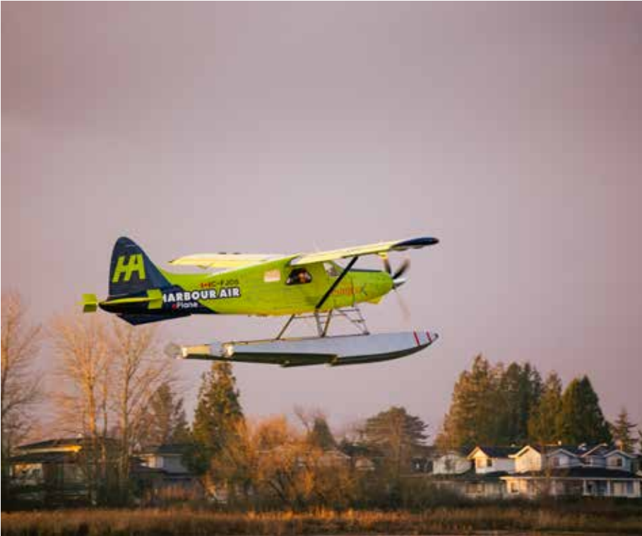
MagniX'in itme sistemini yarattığı elektrikli uçak, sıfır karbon emisyonuyla uçuş gerçekleştiriyor.
