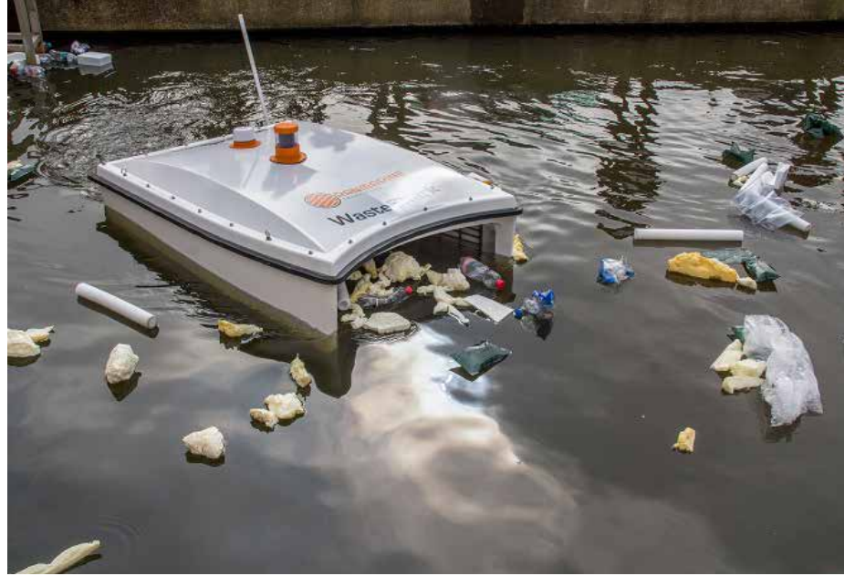
RanMarine'in geliştirdiği WasteShark, limanlarda biriken plastikleri ve biyo-atıkları topluyor.
